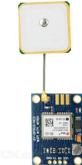
Fig. 6 GPS GY-GPSV3-NEO-7M module
